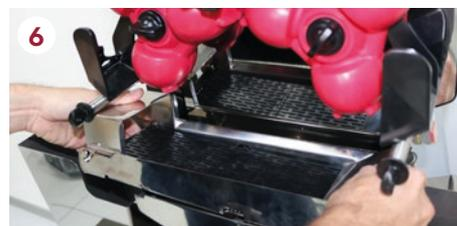
6 Retiramos el **Sistema PulpOut automático**, levantando el conjunto desde la parte más próxima a nosotros.
