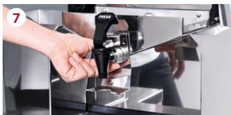
7 Desmontamos el **grifo Speed Up** desenroscándolo fácilmente.
