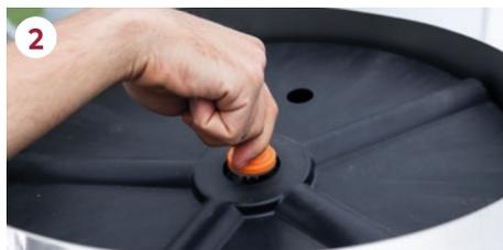
2 Desmontamos el **plato alimentador** desenroscando el pomo central.
