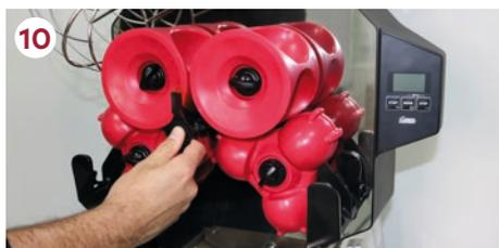
10 Desmontamos la **cuchilla** presionando en el centro y tirando del asa hacia nosotros. **¡Atención!** Cuidado con la zona de corte.
